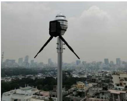
L'émetteur Contact@ir® MD est branché et solidement fixé sur le produit Contact@ir® Ready (ici Paraton@ir®). La recherche et la configuration du meilleur réseau mobile disponible est automatique.
