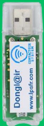
L'émetteur Contact@ir® communique en permanence l'état de fonctionnement du Paraton@ir®. L'émission du Contact@ir® est régulière toutes les 100 secondes - 24h/24
